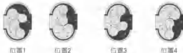
图2 气体涡轮流量计工作原理
